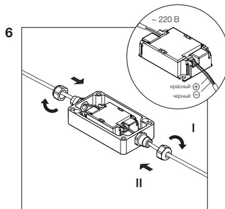
6 Подключите световой модуль (поз. 2) к блоку питания (поз. 3). Блок питания к электросети (см. схему подключения).
