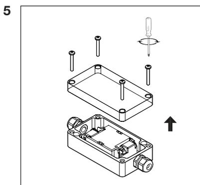
5 Снимите крышку блока питания.
