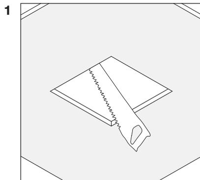
1 Сделайте отверстие в гипсокартонном потолке ( для моделей C50/C85 200x200 - 394 мм, для моделей C 50/C85 100x100 - 294 мм).
