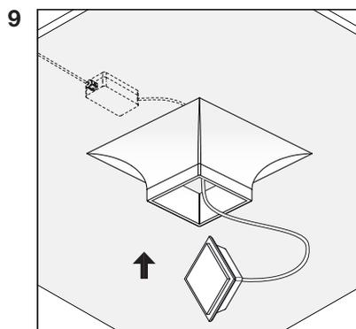
9 Устанавливать световой модуль в корпус следует, предварительно повернув его под 90° от рабочего положения.
