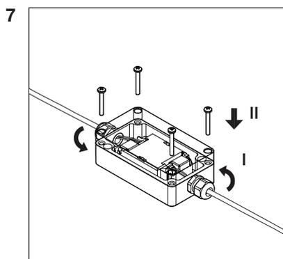
7 Закрепите провода и крышку блока питания.
