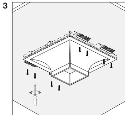
3 Установите корпус (поз. 1) в отверстие и закрепите его с внешней стороны потолка саморезами, идущими в комплекте (поз. 8).
